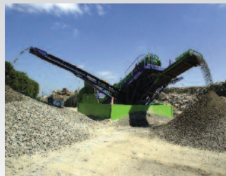
Ces blocs font l'objet d'un scalpage ; les gros éléments sont ensuite concassés pour constituer la Grave Concassée Industrielle et les Cailloux Industriels.
